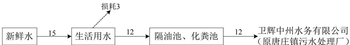
图 3-4 本项目新鲜水用量平衡图 单位： $\text{m}^3/\text{d}$
